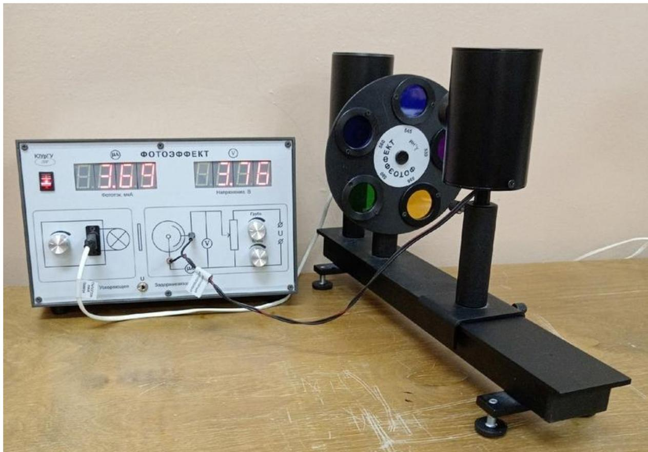
Рис. 1. Лабораторная установка по изучению фотоэффекта в БФ ПНИПУ
